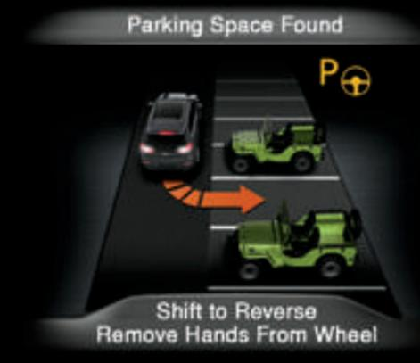
Il sistema di assistenza al parcheggio ParkSense® per manovre in parallelo e in perpendicolare opzionale è visualizzato al centro del quadro strumenti e guida il conducente nelle manovre di parcheggio. Nello specifico, il sistema riconosce i parcheggi liberi e con la semplice pressione di un pulsante controlla il veicolo dando istruzioni al conducente per cambiare le marce, frenare e accelerare.
