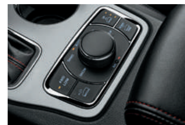
SELEC-TERRAIN® CON ASSISTENTE ALLA PARTENZA IN SALITA E IN DISCESA
